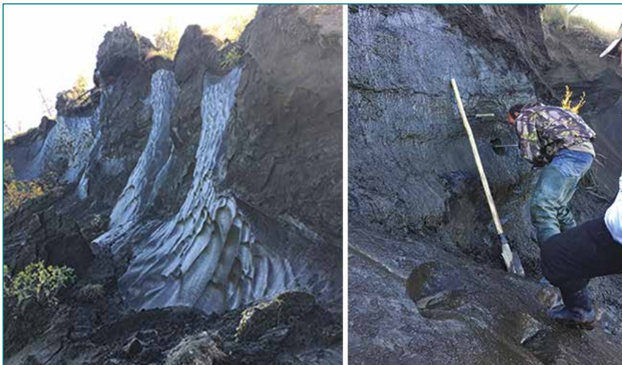
Fig. 2 : A gauche, falaise de pergélisol (site de Duvanny Yar) attestée par la présence de « coins de glace » (zones brillantes) contemporains de la congélation du sol ; à droite, l'échantillonnage du pergélisol. Source : IGS-CNRS.
